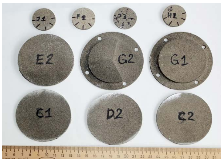
Рисунок 2 – Образцы из стали изготовленные на 3D принтере.
