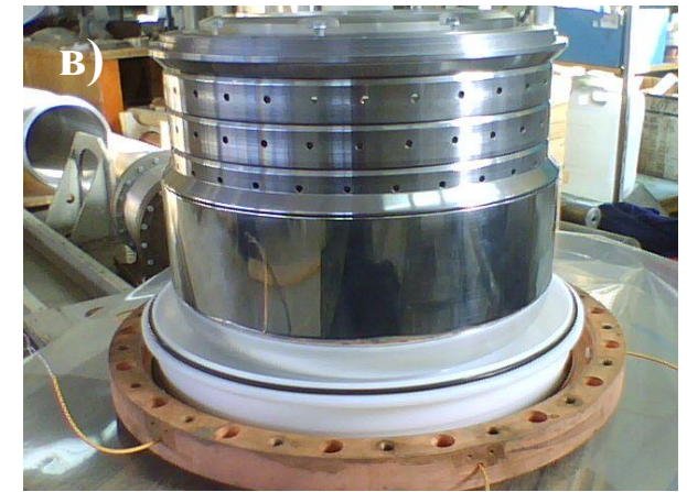
Рис. 5. Общий вид : экспериментального устройства –а); ЭВФРТ в виде «змейки» - б); вакуумного разрядника - обострителя - в).
