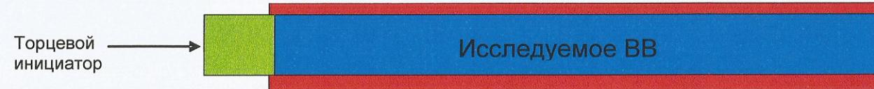
Образец ВВ располагался в зазоре между двумя коаксиальными трубками из стали.
