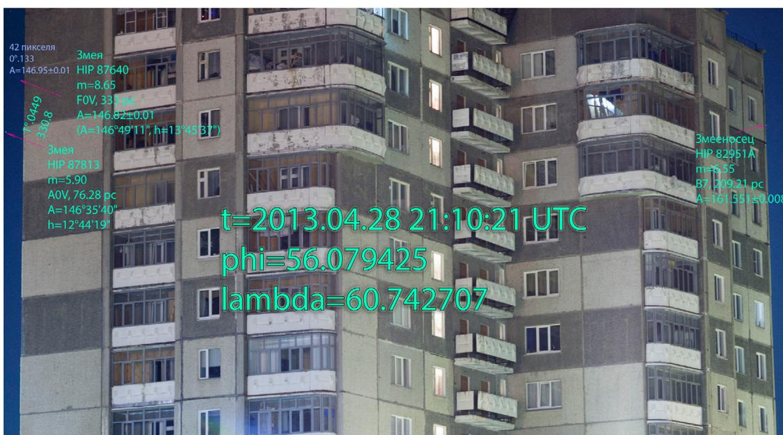
Рис. 3. Определение азимутов рёбер дома по звёздам HIP 87640 и HIP 82951A. Азимут левого ребра равен  $146,95^{\circ} \pm 0,01^{\circ}$ , азимут правого ребра равен  $161,551^{\circ} \pm 0,008^{\circ}$ . Расстояния до рёбер равны 143 и 161 м соответственно
