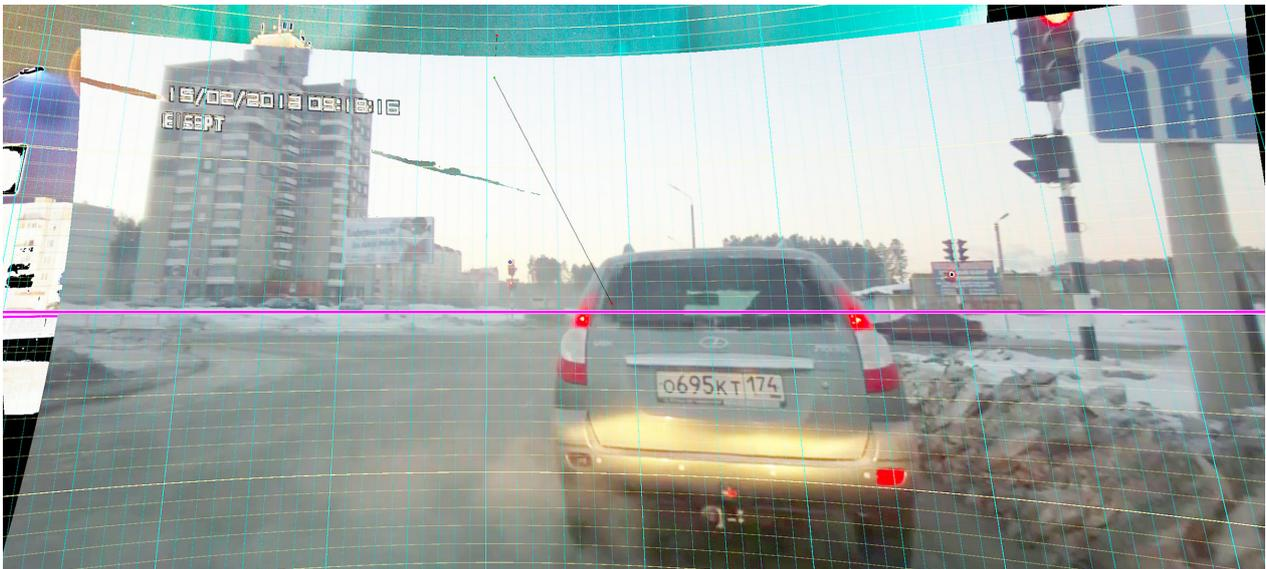
Рис. 5. Пример наложения альт-азимутальной сетки. Сначала находятся параметры калибровочного снимка со звёздным небом, затем кадр из видеозаписи совмещается по очертаниям предметов с калибровочным кадром, после чего наносится альт-азимутальная сетка
