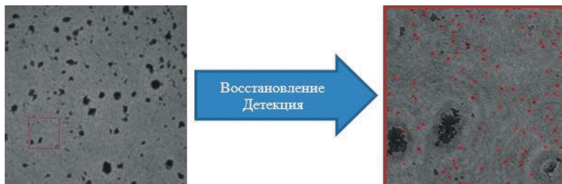
Рис. 2. Экспериментальная голограмма (слева) и восстановленный слой с работой детектора мелких частиц (справа)
