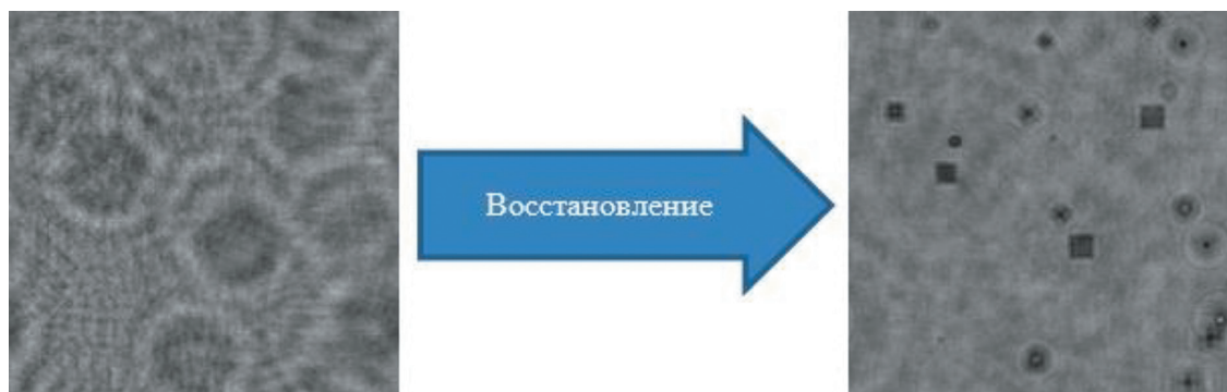
Рис. 1. Пример исходной синтетической голограммы (слева) и восстановленный слой на некоторой глубине (справа)
