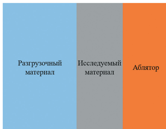
Рис. 1. Общая схема мишени в эксперименте по изоэнтропическому сжатию
