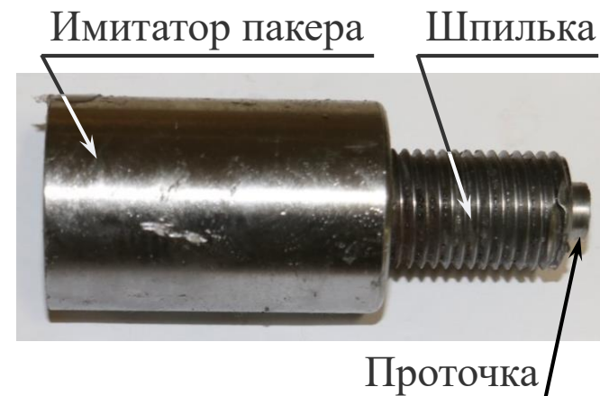
Фрагмент шпильки из стали 40Х с имитатором пакера после разрыва
