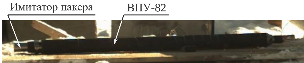
ВПУ-82 с имитатором пакера перед взрывом
