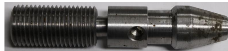
Шпилька из стали 40Х перед испытанием
