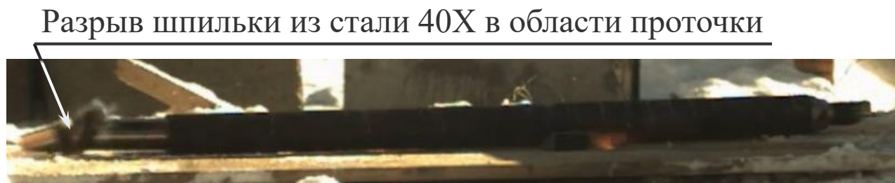
ВПУ-82 с имитатором пакера в момент разрыва шпильки
