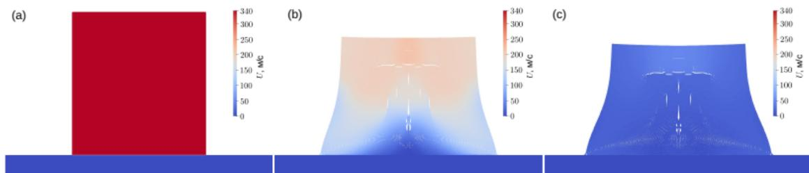
Моделирование удара стального цилиндра по твёрдой стенке. Начальная длина цилиндра  $L_0 = 0.81$  см, диаметр равен  $D_0 = 0.762$  см. Скорость удара равна 343 м/с. Раскраска выполнена по скорости. (a) Момент соударения, (b) 5 мкс (c) 11 мкс.
