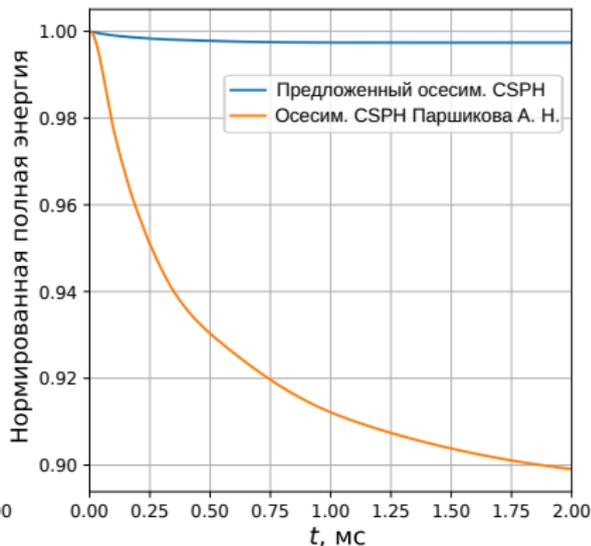
Изменение полного импульса и полной энергии в задаче о столкновении двух капель жидкого олова при использовании предлагаемой осесимметричной схемы CSPH “среднее гармоническое” и схемы осесимметричного метода CSPH А.Н. Паршикова [Parshikov и др. 2000].
