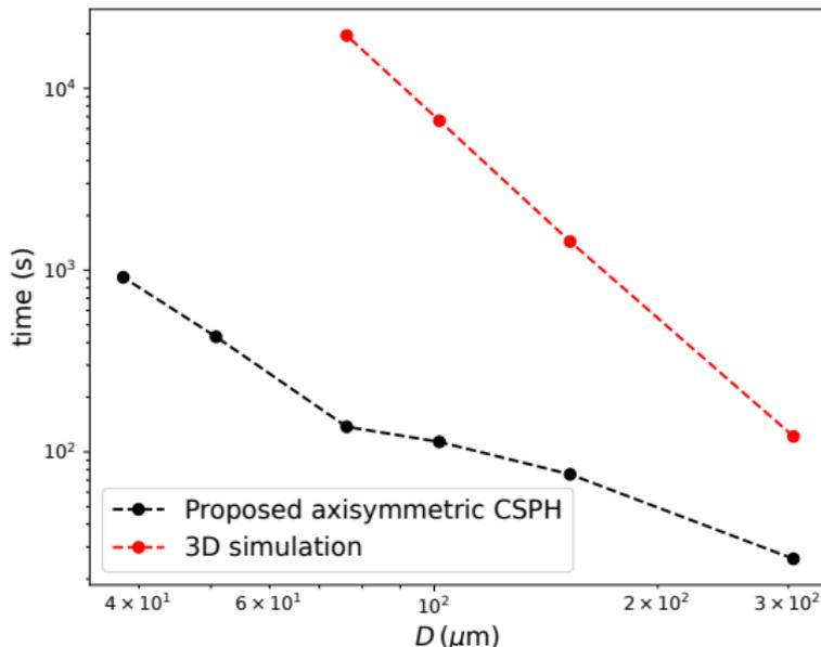
Сравнение времени моделирования удара стального цилиндра по твёрдой стенке методом MUSCL-SPH при разных размерах частиц в двумерном осесимметричном случае и в трёхмерном декартовом случае на 16 вычислительных ядрах.
