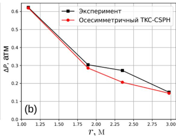
Максимальный прирост давления в датчиках по отношению к атмосферному давлению в первом эксперименте: (а) взрыв в воздухе, (б) взрыв в защитном песчаном цилиндре.
