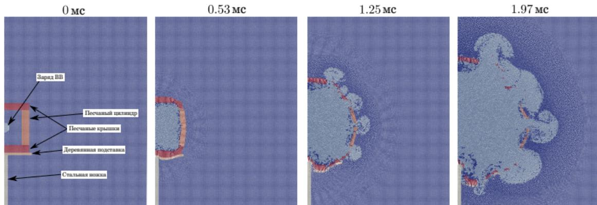
Взрыв внутри песчаного цилиндра в первой постановке: динамика разрушения песчаной преграды. На рисунках показано распределение материалов в разные моменты времени.
