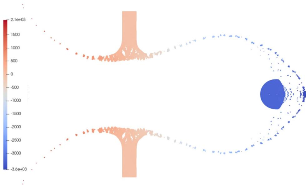
Пробитие тонкой преграды РММА стальным шариком. Моделирование производилось осесимметричным методом MUSCL-SPH.  $H = 3.28$  мм,  $U = 3460$  м/с. На рисунке представлен момент времени 11.7 мкс.
