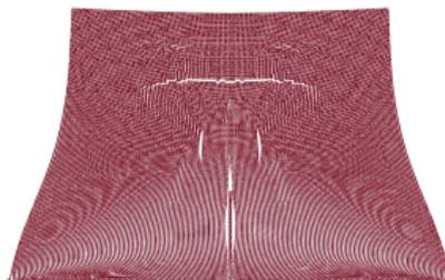
Сравнение результатов моделирования удара стального цилиндра по твёрдой стенке трёхмерным методом MUSCL-SPH в декартовых координатах и предлагаемым осесимметричным методом MUSCL-SPH. Начальная длина цилиндра  $L_0 = 0.81$  см, диаметр равен  $D_0 = 0.762$  см. Скорость удара равна 343 м/с. Показан момент времени  $t = 11$  мкс.
