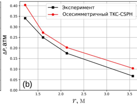
Максимальный прирост давления в датчиках по отношению к атмосферному давлению во втором эксперименте: (а) взрыв в воздухе, (б) взрыв в защитном песчаном цилиндре.
