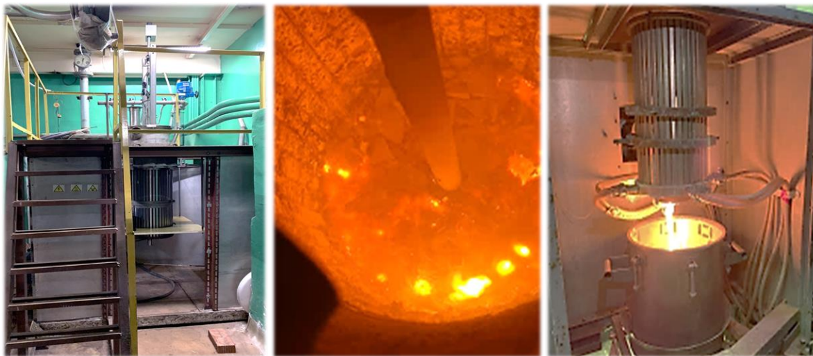
Полномасштабная установка остекловывания ВАО на основе ИПХТ в процессе приготовления стекла и выливки продукта
