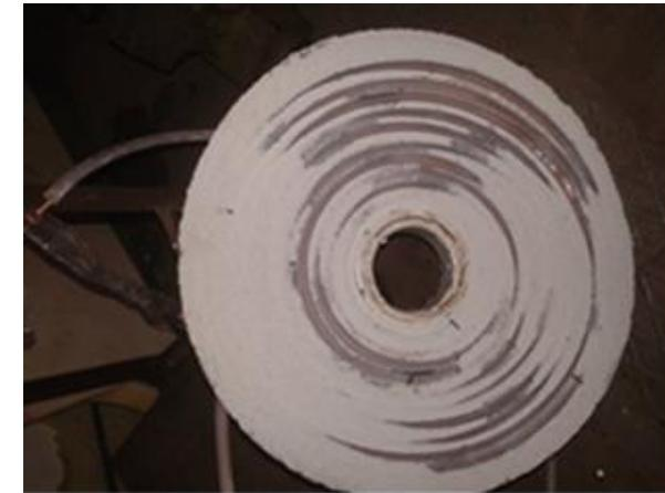
Более 20 индуктивных накопителей было изготовлено и испытано. Витки заливались полиэфирными смолами с наполнителями, на который приклеивались керамогранит, стекла, зеркала либо наносилась эпоксидная смола, акрил. ВСЕ долго не выдерживали из-за ударных нагрузок и мощного рентгеновского излучения.
