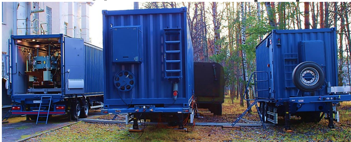
Рисунок 1. Фотография мобильного генератора гамма-излучения: слева – ускорительный модуль, по центру – модуль управления и контроля, справа – модуль импульсного питания электромагнита.
