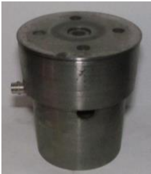
Датчик дульной скорости Калибр 8 мм Калибр 45 мм. Типичная осциллограмма
