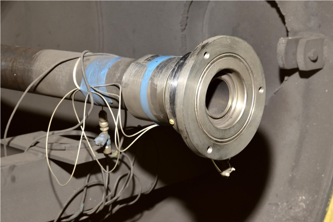
Экспериментальное блокирующее сечение. Индукционный датчик пролета.
