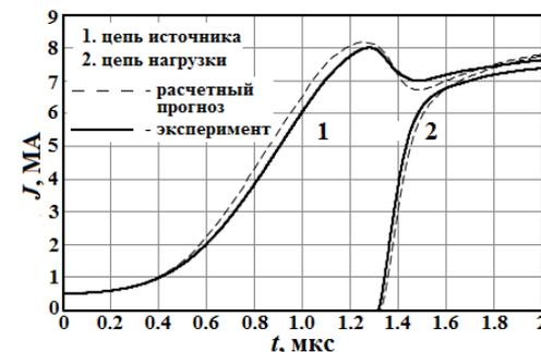
Зависимости от времени токов в цепи источника и нагрузки.
