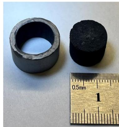
Образец аэрографита, полученный в керамическом кольце
