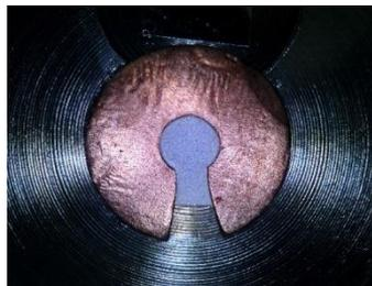
Фото шайбы с аэрогелем в мишенной конструкции
