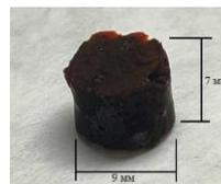
Фото образца РФ-аэрогеля
