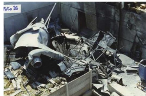
Фильтр до и после взрыва алюминиевой пыли
