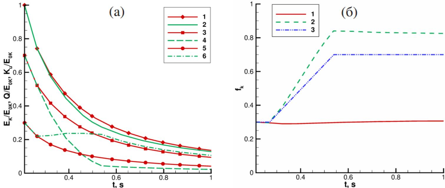
Зависимости от времени (а) полной кинетической энергии (1, 2), турбулентной кинетической энергии разрешённых пульсаций (3, 4) и турбулентной кинетической энергии неразрешённых пульсаций (5, 6), (б) расчётного значения  $f_k$  для расчёта с постоянным значением  $f_k = 0.3$  и расчёта в третьем варианте ( $P_f \neq 0, \mu_f \neq 0$ ).
