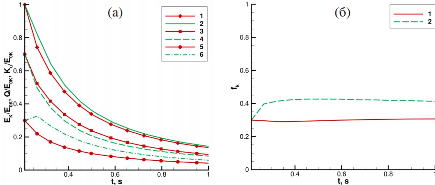
Зависимости от времени (а) полной кинетической энергии (1, 2), турбулентной кинетической энергии разрешённых пульсаций (3, 4) и турбулентной кинетической энергии неразрешённых пульсаций (5, 6), (б) расчётного значения  $f_k$  для расчёта с постоянным значением  $f_k = 0.3$  и расчёта с адаптивным значением  $f_k$ .
