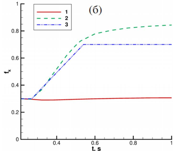
Зависимости от времени (а) полной кинетической энергии (1, 2), турбулентной кинетической энергии разрешённых пульсаций (3, 4) и турбулентной кинетической энергии неразрешённых пульсаций (5, 6), (б) расчётного значения  $f_k$  для расчёта с постоянным значением  $f_k = 0.3$  и расчёта во втором варианте ( $P_f \neq 0, \mu_f = 0$ ).
