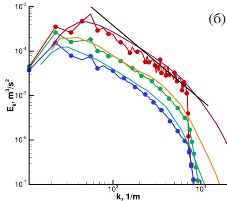
Спектральная плотность турбулентных пульсаций в различные моменты времени: (а)  $N = 64$ , (б)  $N = 128$ . Кривые с маркерами соответствуют численным данным, без маркеров – экспериментальным. Сплошная кривая соответствует колмогоровскому спектру с константой  $C_K = 1.37$  и экспериментальным значением скорости диссипации ТКЭ  $\epsilon_0 = 0.474 \text{ м}^2/\text{с}^3$ .
