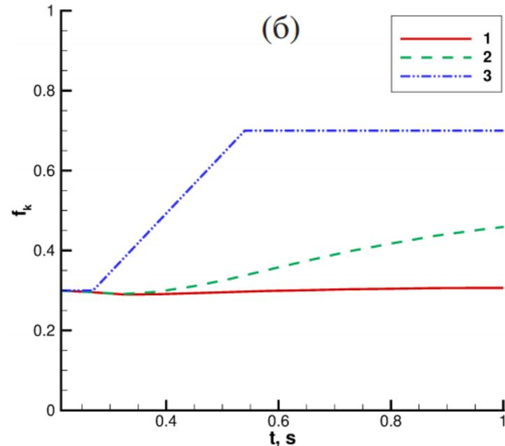
Зависимости от времени (а) полной кинетической энергии (1, 2), турбулентной кинетической энергии разрешённых пульсаций (3, 4) и турбулентной кинетической энергии неразрешённых пульсаций (5, 6), (б) расчётного значения  $f_k$  для расчёта с постоянным значением  $f_k = 0.3$  и расчёта в первом варианте ( $P_f = 0, \mu_f = 0$ ).
