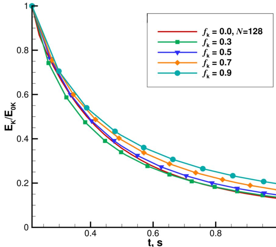
Зависимость нормированной полной кинетической энергии от времени при различных значениях параметра  $f_k$ .
