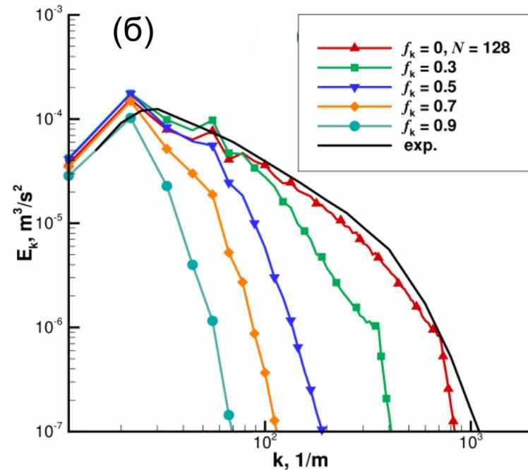
Спектральная плотность турбулентных пульсаций (а) в начальный момент времени, (б) в момент времени  $t_3 = 0.869$  с при различных постоянных значениях параметра  $f_k$ .
