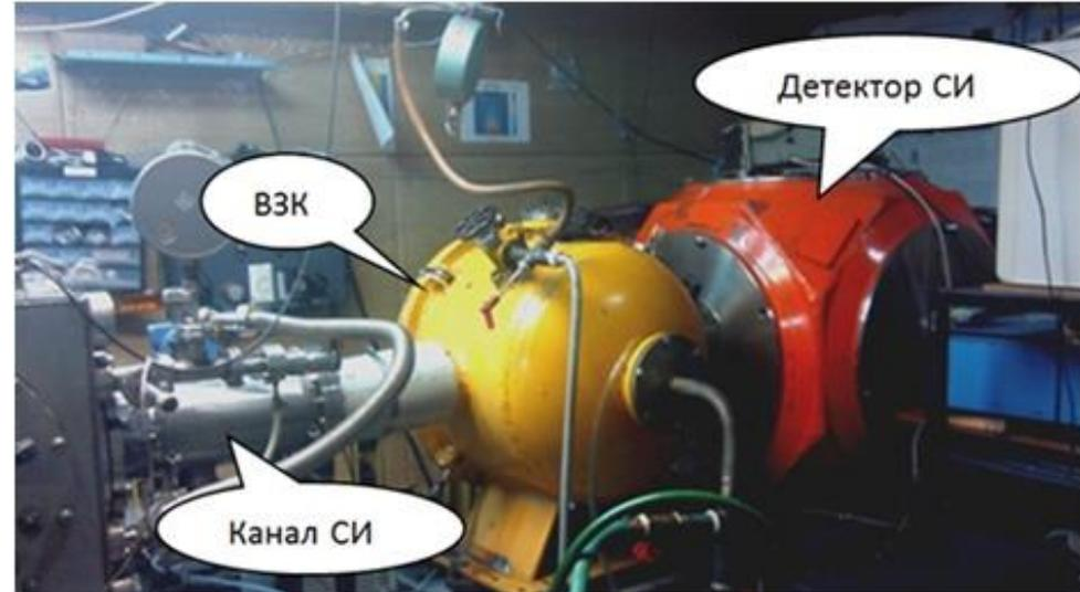
Станция «Взрыв» на ускорителе ВЭПП-3
