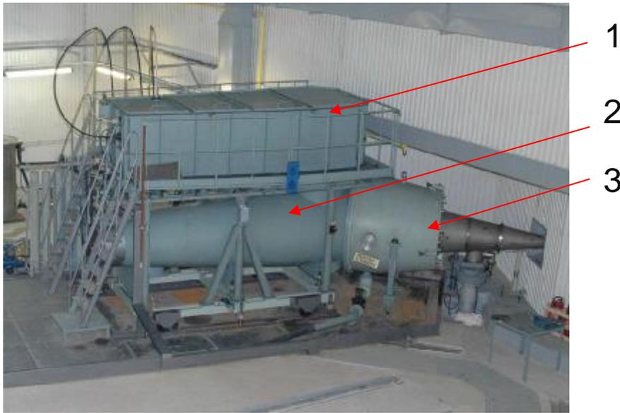
1 – генератор импульсных напряжений; 2 – система формирования импульсов; 3 – ускорительная трубка с род-пинч диодом; 4 – анод; 5 - катод
