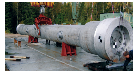
ТУК 84/1 (длина 15 836 мм, диаметр рабочей части 1240 мм, диаметр до 1440 мм, вес пустого контейнера 92 559 кг)
