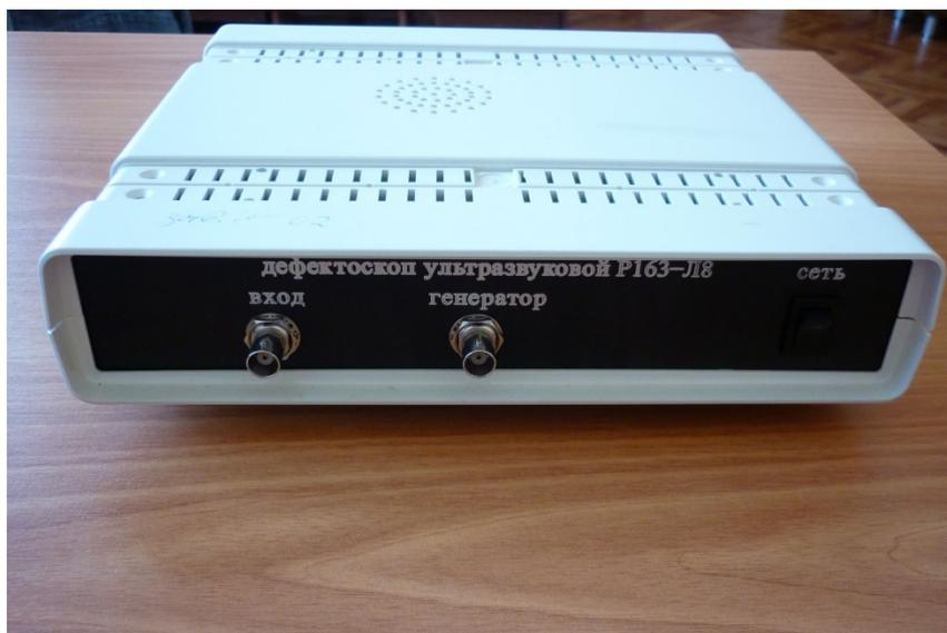
**Рисунок 1 – Передняя панель дефектоскопа**
