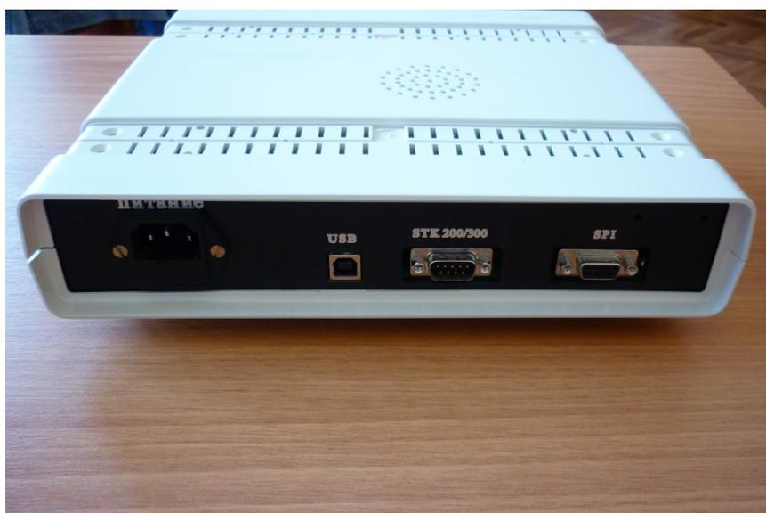
**Рисунок 2 – Задняя панель дефектоскопа**
