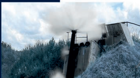
Процесс роста давления в гидрокамере и выдавливания воды из-под крышки через 225мс после начала горения шашки
