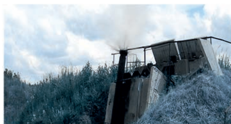
Процесс горения заряда сопровождается ростом давления в гидрокамере и выдавливанием воды из-под крышки
