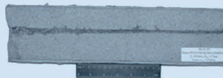
Керн, пробитый зарядом перфоратора ПМИ54 Глубина канала – 410мм Объем канала – 10см 3
