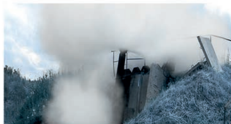
Процесс роста давления в гидрокамере и выдавливания воды из-под крышки через 295мс после начала горения шашки
