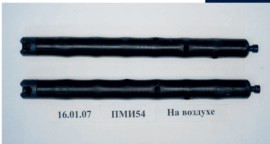
Фото 2: Перфораторы ПМИ54 после испытаний на воздухе
