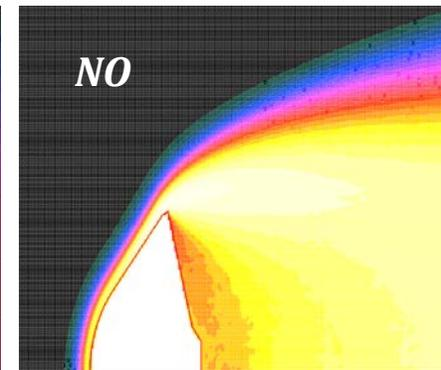
Система *SMILE* основана на методе прямого статистического моделирования Монте-Карло (ПСМ) и разработана в ИТПМ СО РАН. Численное исследование высокоскоростных течений (для скоростей до 8000 м/с) в переходном по числу Кнудсена режиме, характерном для обтекания спускаемого аппарата (СА) на высотах от 70 км до 150 км.
