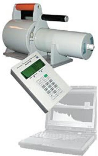
Спектрометр сцинтилляционный (NaI(Tl)) «Гамма-1С/НВ»
