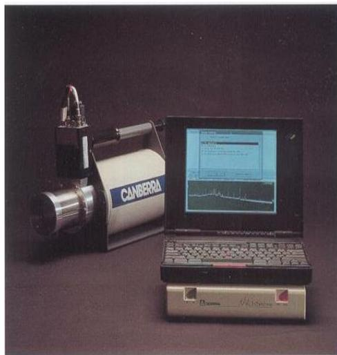
Полупроводниковые (HP Ge) спектрометры (Canberra, ORTEC)
