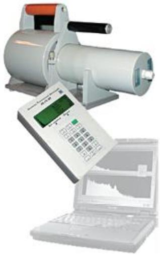
Scintillation (NaI(Tl)) spectrometer «Gamma -1C/NB»
