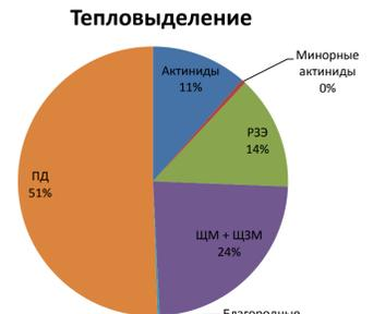
Рисунок 2.4 – Тепловыделение ОЯТ на момент выгрузки
