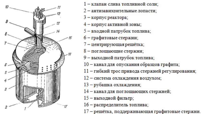
Конструкционная схема MSRE
