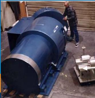
**Перестановочные устройства, рассчитанные на использование как 55-галлонных цилиндрических контейнеров, так и крупногабаритных брусковых образцов, находятся в регулярной эксплуатации**
