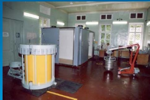
Система верификации атрибутов нейтронных и гамма-потоков (АВНГ), построенная в России в тесном сотрудничестве с ЛАНЛ и установленная на оружейном объекте ВНИИЭФ в Сарове, Россия
