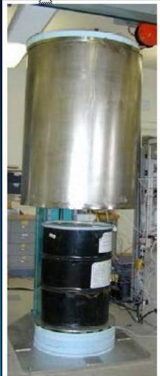
Для измерения полного количества тепла, вырабатываемого объектом исследования, содержащим ядерный материал, может применяться метод прямой калориметрии.
