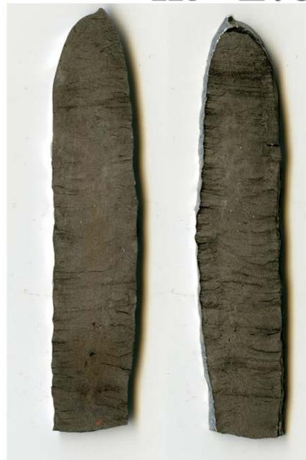
Образцы Re после сдвига под давлением 14 ГПа: а- исходное состояние, б-  $\varphi=15^\circ$ , в -  $45^\circ$ , г -  $90^\circ$ , д- $180^\circ$ , е -  $360^\circ$
