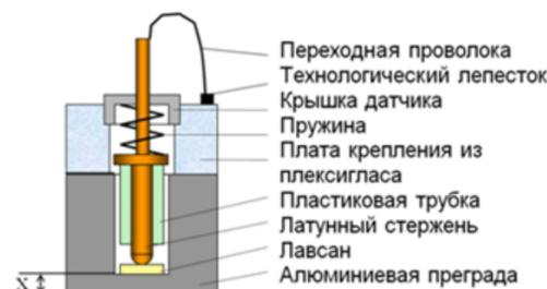
Рисунок 2 – Схема установки электроконтактного датчика
