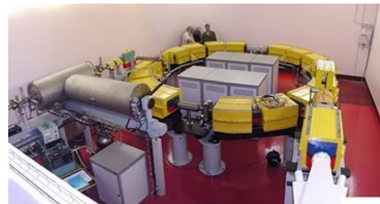
Сборка протонного терапевтического комплекса в Протвинской городской больнице
