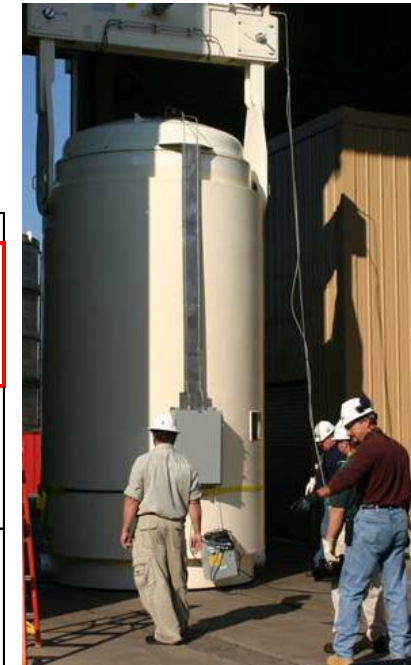
Контейнер TN-32В для проекта сбора данных по ОЯТ с высоким выгоранием
