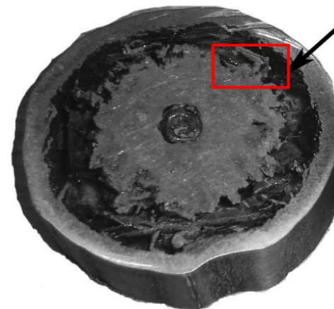
трещины и край магистральной трещины
