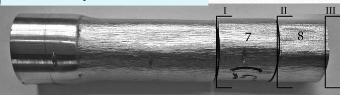
наружный диаметр уменьшился до 21,5 мм, толщина стенки возросла до 2,5 мм, т.е. относительная радиальная деформация составила ~ 25%.
