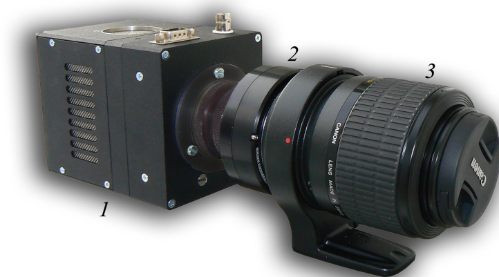
Рисунок 2 – Канал многокадровой системы регистрации радиографического комплекса.
