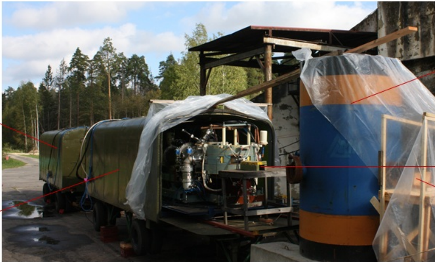
1 – ускорительный модуль; 2 – модуль импульсного питания электромагнита бетатрона; 3 – ВЗК; 4 – система коллимации рентгеновских лучей; 5 – система регистрации теневых изображений.
