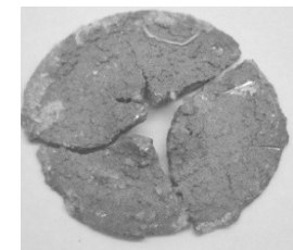
Эксперимент №107 \tau=0,68 мкс, V_0=626,9\pm 1,9 м/с
