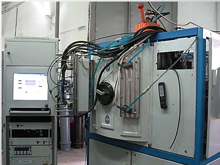
метод вакуумного напыления позволяет нанести внешний слой меньшей проводимости толщиной **менее 100 мкм** на проводник и дает возможность изготавливать двухслойные электроды сложной конфигурации
