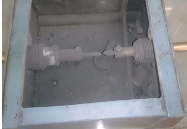
Разрушенный контейнер в экспериментальной камере
