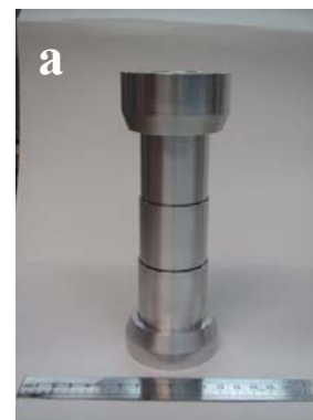
Мишенный блок с Be : до эксперимента –а; после эксперимента –б.
