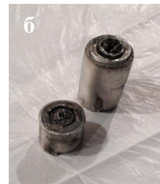
Мишенный блок с Be : до эксперимента –а; после эксперимента –б.
