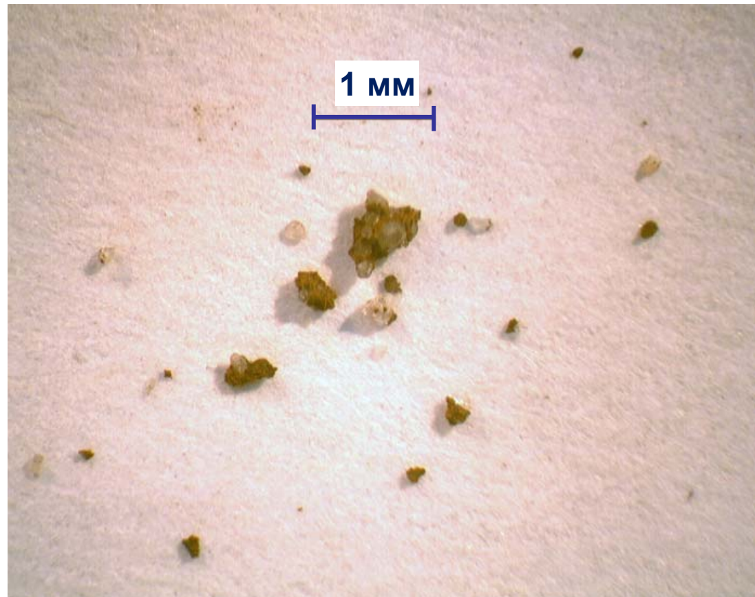
Осколки мишени \varnothing 4 мм, собранные после эксперимента
