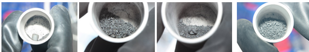
Рис. 2. Результат нитрирования мононитрида урана.
