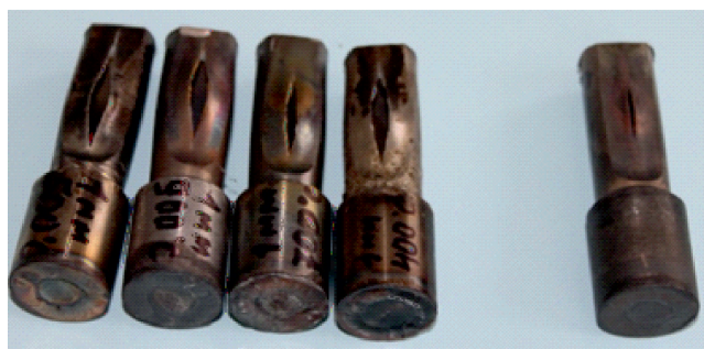
Трубы 18×3 мм из стали ЭП302М-Ш с ослабленным сечением (лыска), минимальная толщина стенки 1 мм
