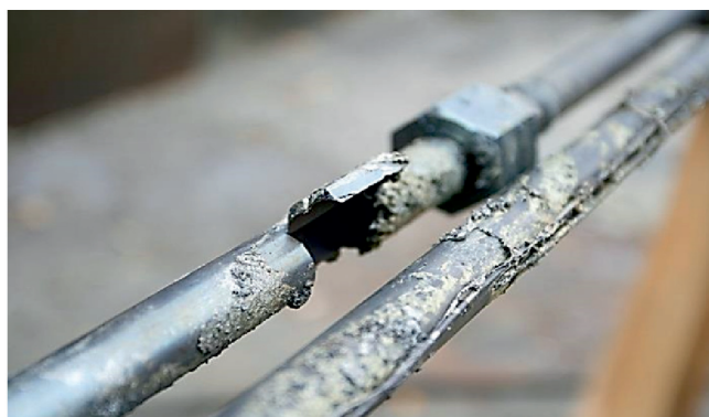
Рис. 21. Вид трубы-мишени 18×2,5 мм из стали 12X18H10T после испытаний в жидком свинце ( 520 \text{ }^\circ\text{C} )
