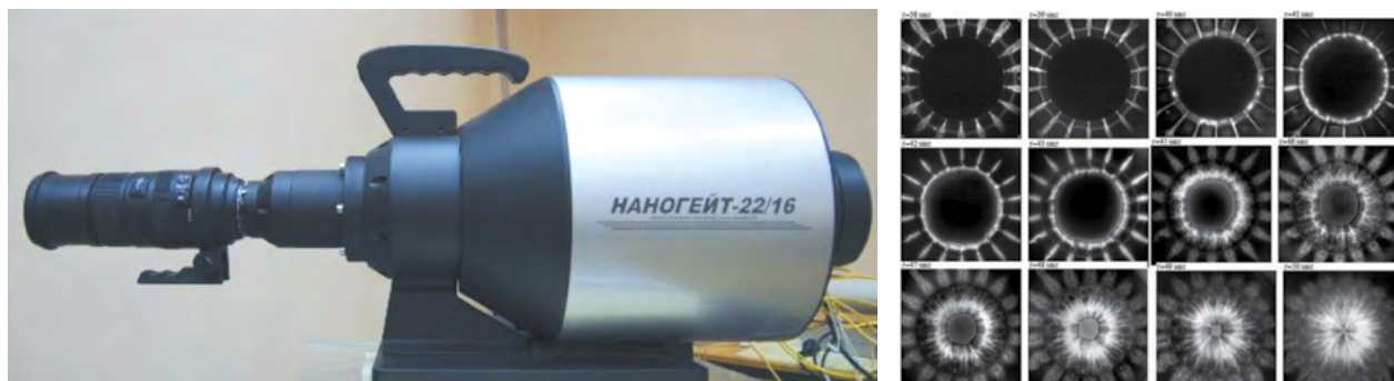
Рис. 1. Слева – Камера «Наногейт 22/16», справа – регистрация процесса детонации, 12 кадров из 16-ти
