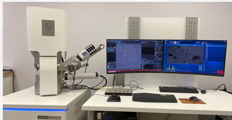
Сканирующий электронный микроскоп Tescan Mira LMS, ЦКП «Геоаналитик» ИГГ УрО РАН
