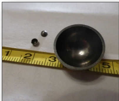
Рисунок 5 - Полусферические оболочки наружным диаметром 18 мм и 3 мм из вольфрама, изготовленные методом электроэрозионного формообразования
