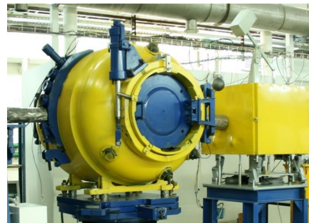
ВЭПП-4. Взрывная камера на 200 г.
