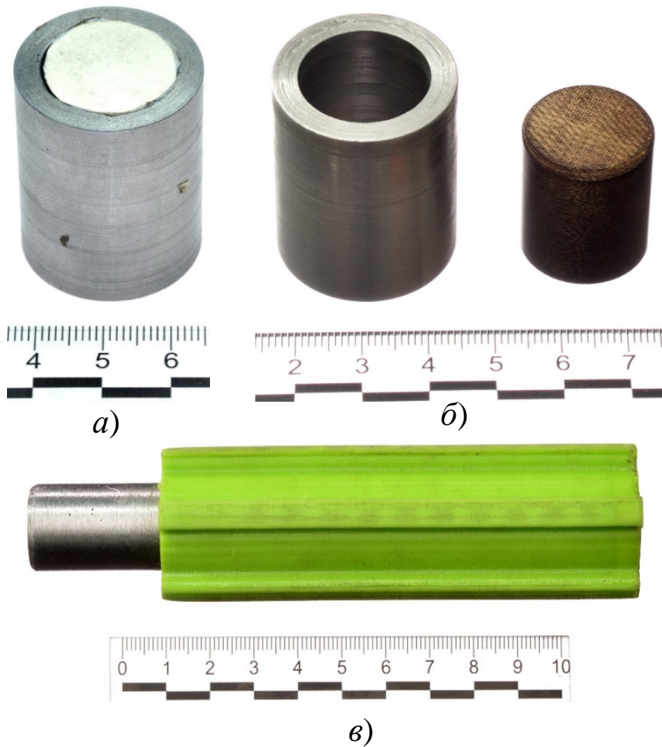
Рисунок 8 – Общий вид снаряда-заглушки, запрессованного в сопло (а, в) и дополнительной массы (б)
