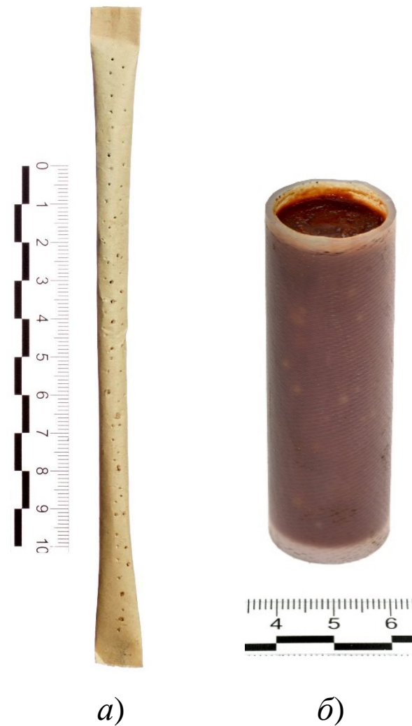
Рисунок 9 – Общий вид перфорированного картуза с традиционным порохом (а) и негорящего имитатора топлива (б)
