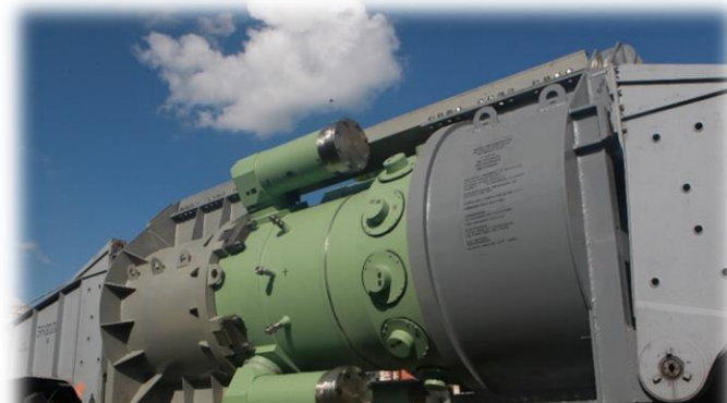
Транспортировка корпуса реактора (АО «ЗиО-Подольск»)
