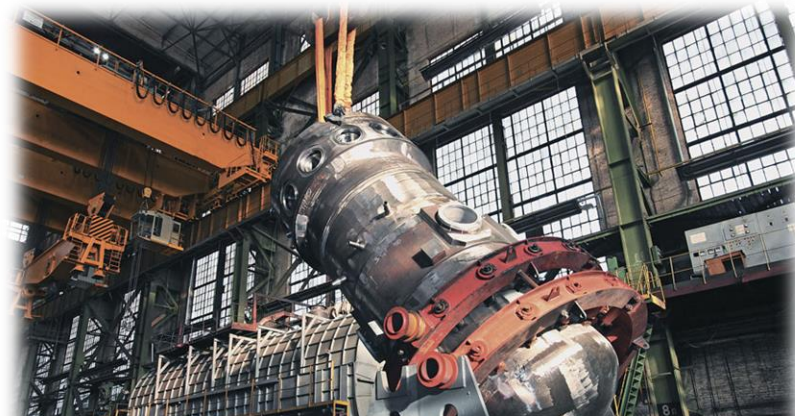
Установка корпуса РУ РИТМ-200 в специальный стапель в вертикальном положении (АО «ЗиО-Подольск»)
